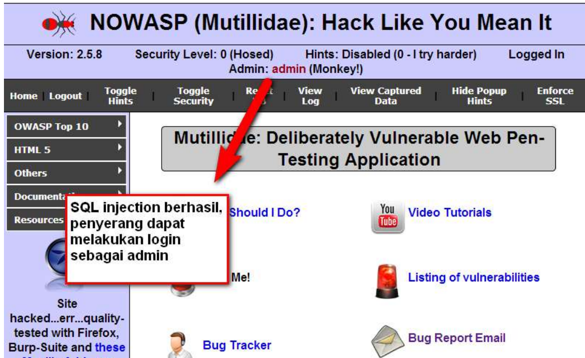
Gambar 6. SQL injection pada mutillidae berhasil dilakukan
