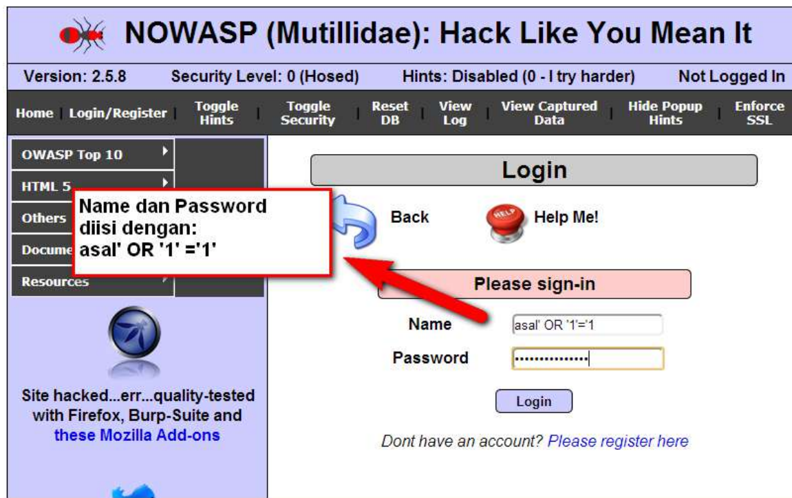
Gambar 5. Input SQL injection pada mutillidae
